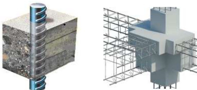
Figura 5. Concreto adherido a barras corrugadas.
